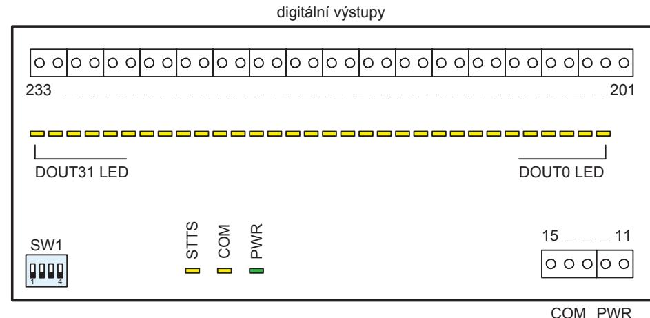
**Poznámka:** Na obrázku zakreslené LED signalizují přítomnost napájecího napětí (PWR), aktivitu komunikační linky (COM) a sepnutí digitálních výstupů (DOUTxx LED). LED označená STTS má význam pro režim aktualizace firmware.
